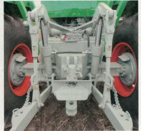
Kraftheber, Kupplung und Hydraulikanschlüsse im Fokus: Die Zapfwelle sucht man vergebens
