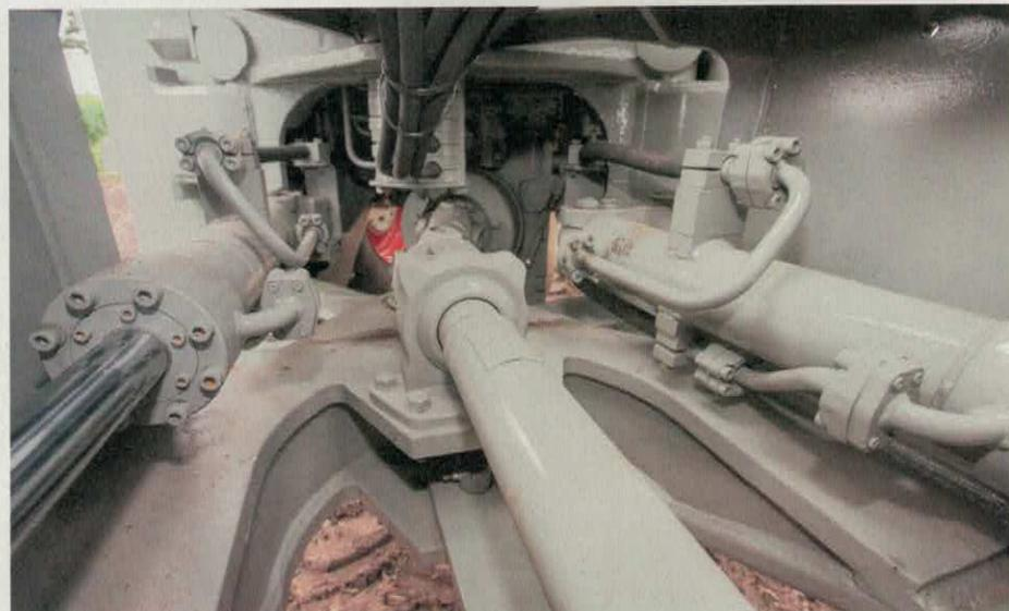
„Einmal wechseln bitte“ kann ins Geld gehen: Die hydraulische Anlage will nicht zuletzt dank Knicklenkung mit 150 Liter SAE 10 gefüllt sein. Insgesamt arbeitet der D16006 mit 236 Liter Öl
