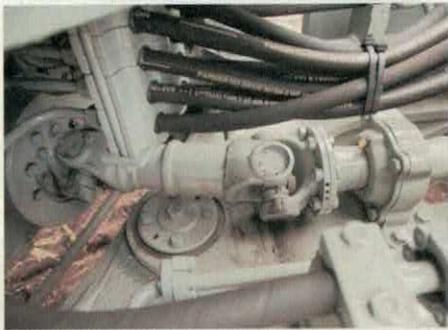
Die Kardanwelle für den Antrieb der Hinterräder ist vor dem „Knick“ noch einmal gelagert (rechts)
